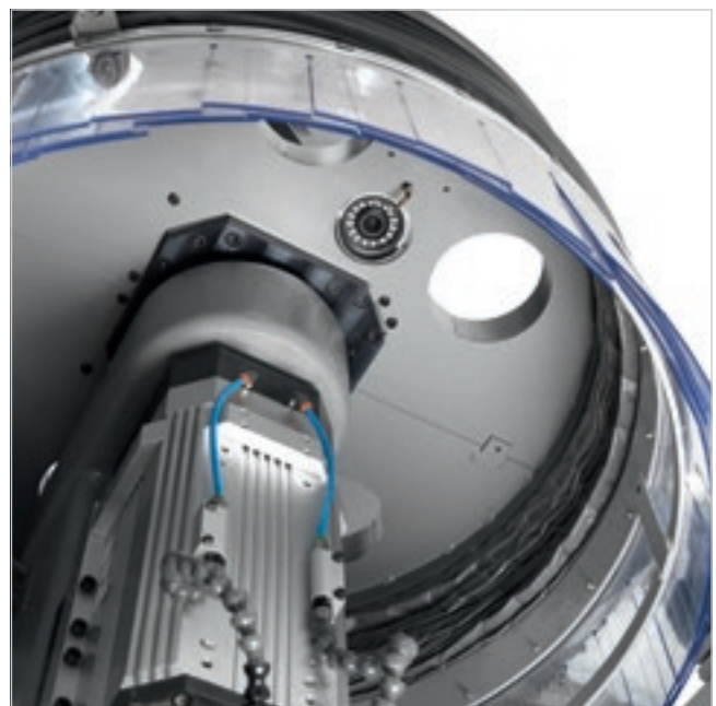
Sistema di lettura di posizione con telecamera per il centraggio di pannelli di grandi dimensioni per mezzo di un ciclo di rototraslazione del programma di lavorazione.
