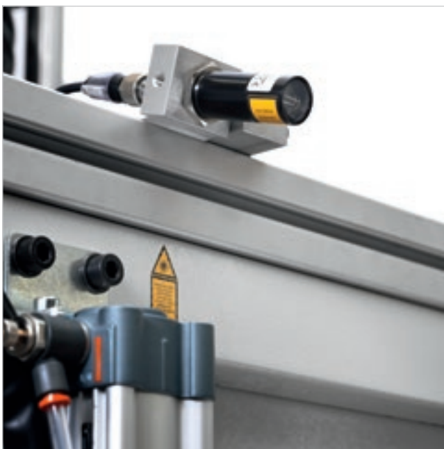
Sistema di allineamento pannello tramite laser linea a bordo portale mobile.
